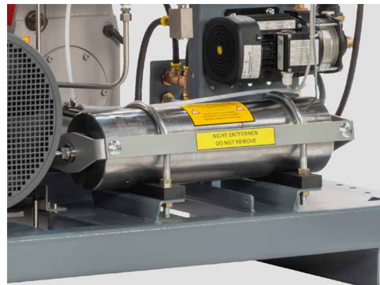
GERINGE DRUCKSCHWANKUNGEN DURCH EINGEBAUTEN PULSATIONS-DÄMPFER, DARAU S FOLGT GUTE SCHNITTKANTENQUALITÄT.
