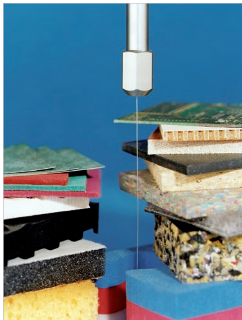
Verschiedene Materialien, geschnitten mit dem reinen Wasserstrahl.
